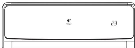
При утере пульта ДУ или выходе из строя элементов питания управление кондиционером производится следующим образом: на панели управления под дисплеем находится кнопка ON/OFF, с помощью которой можно включить или выключить кондиционер.
