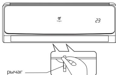
Регулирование направления потока воздуха в вертикальной плоскости выполняется поворотом горизонтальных жалюзи с пульта дистанционного управления с помощью клавиши ◀▶.
