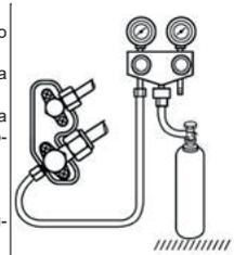
Отключите вакуумный насос от манометрического коллектора.
